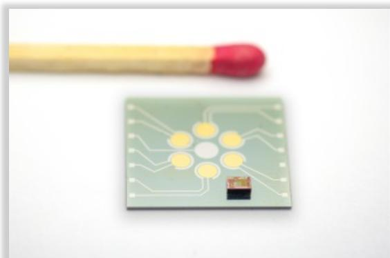
**Mit einer integrierten Auswerteschaltung des Fraunhofer IIS kann das Biosensorsystem der Fa. CapSenze auf die Größe einer Streichholzschachtel reduziert werden.**
