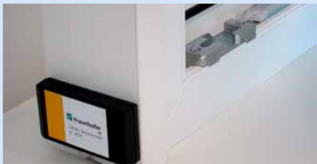
Der am Fensterrahmen angebrachte Sensorknoten (hier ein Prototyp) überträgt die Daten über ein drahtloses Sensornetz.
