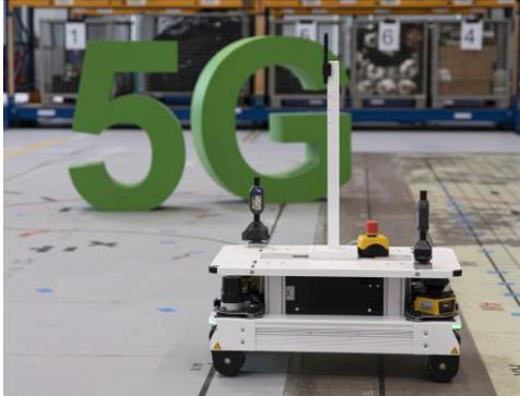
**Live-Lokalisierung in 5G eines mobilen Roboters im 5G Bavaria Testbed »Industrie 4.0« im Nürnberger Nordostpark © Fraunhofer IIS/Paul Pulkert | Bild in Druckqualität: [www.iis.fraunhofer.de/pr](http://www.iis.fraunhofer.de/pr).**
