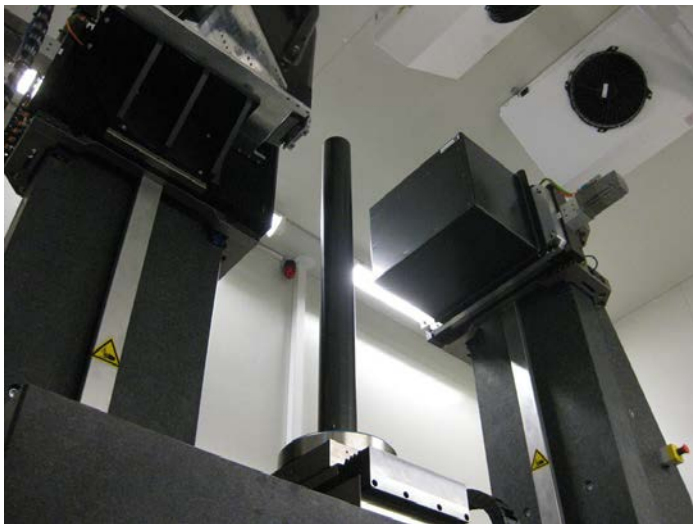
Der Aufbau einer Helix-CT-Anlage zur Eisbohrkernprüfung innerhalb einer strahlenresistenten Kühlkammer. © Fraunhofer IIS | Bild in Farbe und Druckqualität: www.iis.fraunhofer.de/pr .
